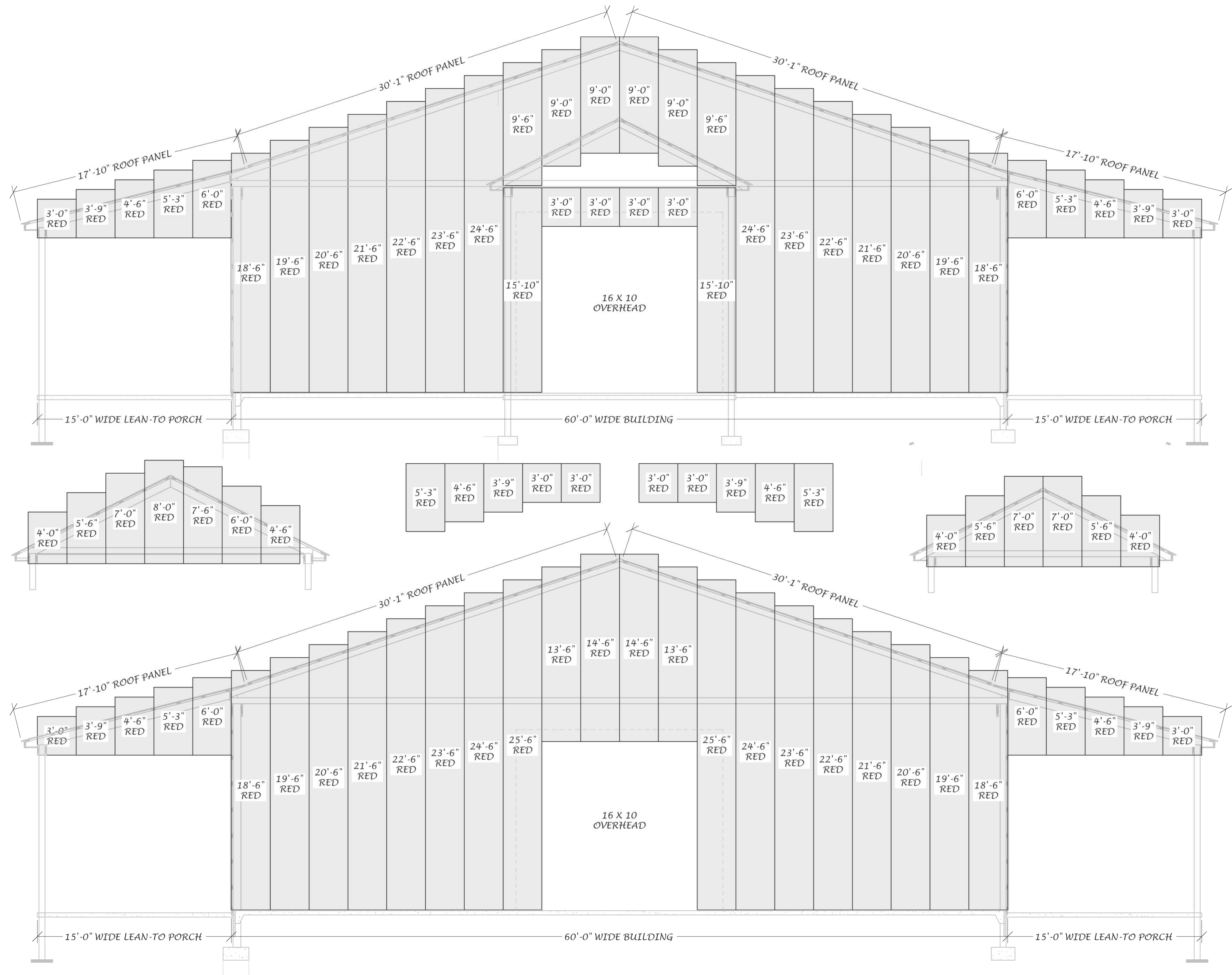
LO1 STEEL WALL LAYOUT A SCALE: 1/4" = 1'-0"
